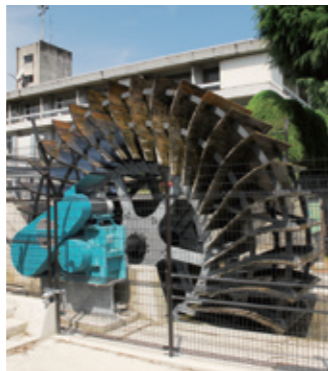
家中川小水力市民発電所「元気くん1号」(マイクロ水力発電) 写真提供：都留市産業観光課
